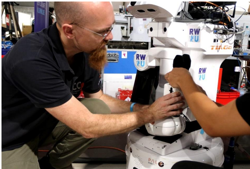
Benjamin Stähle beim Auswechseln eines sogenannten Greifers von einem der RWU-Roboter.
